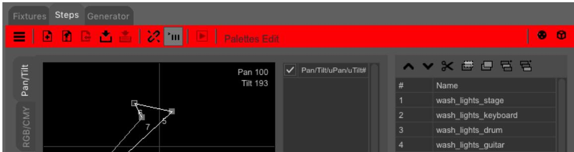
Die rote Symbolleiste bedeutet, dass Sie sich im Paletten-Bearbeitungsmodus befinden. In diesem Modus entspricht jede Zeile in der Liste „Schritte“ einem Speicher des Kanalwerts. Dann können Sie diese „Speicher“ in Steps und Generator verwenden. Das Ziel besteht darin, diese gespeicherten Werte ändern zu können, ohne mehrere Szenen bearbeiten zu müssen, in denen sie verwendet werden. Klicken Sie zum Beenden der Paletten-Bearbeitung in der Symbolleiste auf „Neu“ oder laden Sie eine Lichtszene.
