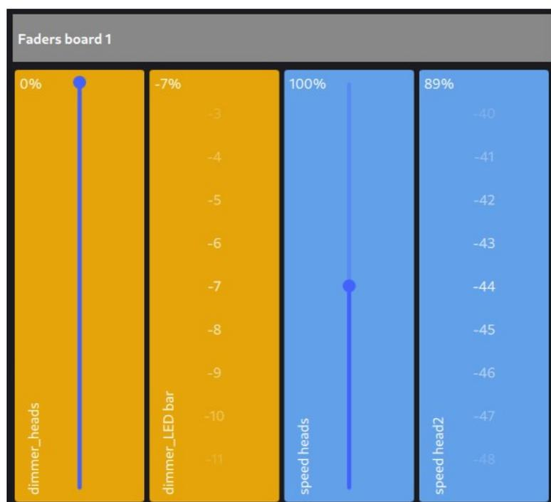
Cette carte contient des curseurs et des sélecteurs rotatifs pour le contrôle des gradateurs sur les canaux, ou le contrôle de la vitesse sur les boutons de scène.
